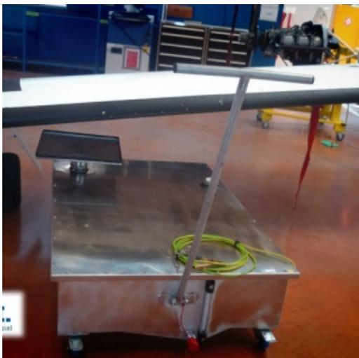
**Entonnoir ajustable :** L'entonnoir doit être positionné à la verticale du robinet de vidange. Cet entonnoir est supporté par un tube coulissant et une rotule qui permettent d'ajuster celui-ci à la forme de l'aile. Afin d'éviter les éclaboussures. La purge se fait par gravité.
